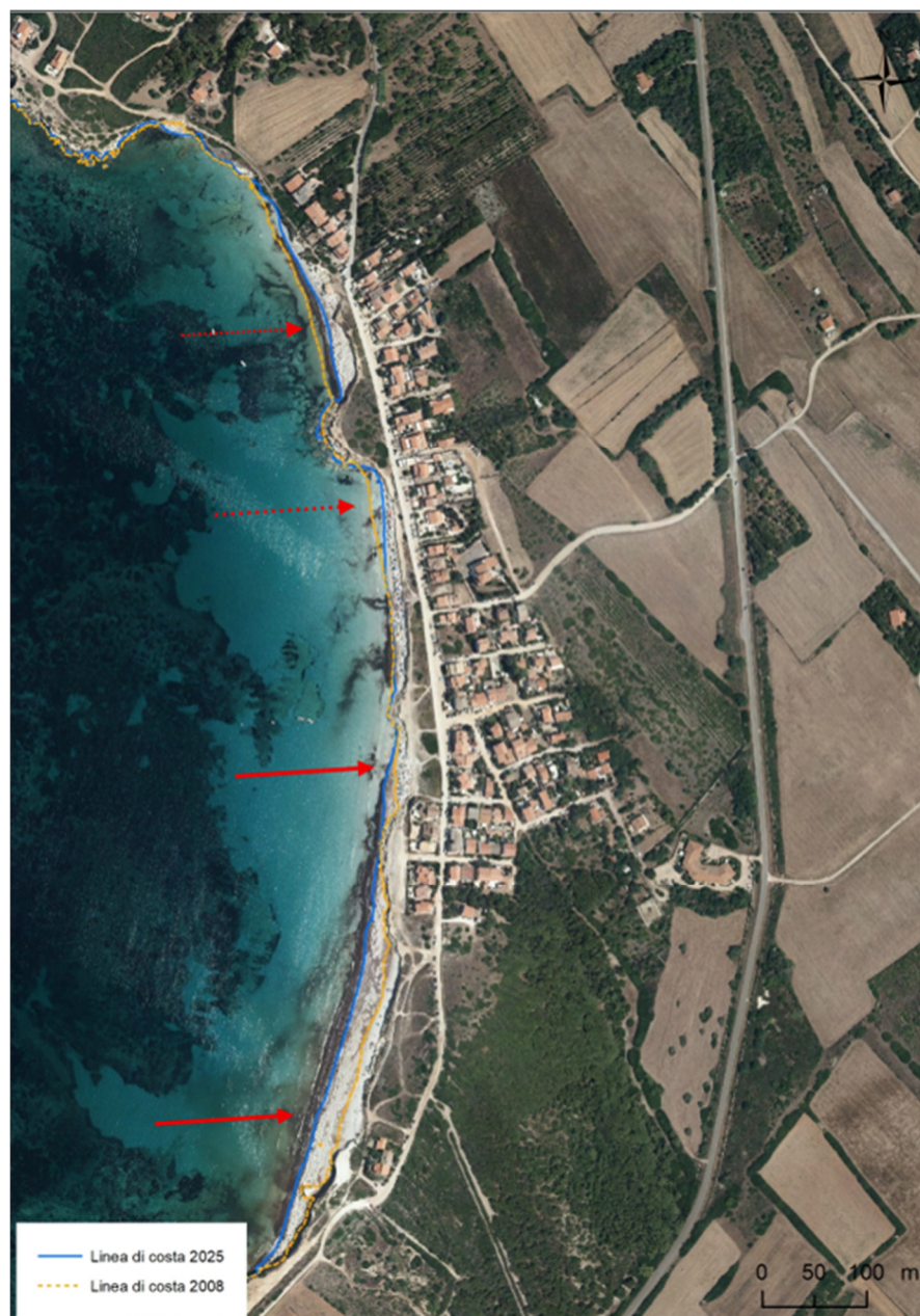
Figura 2. Confronto tra le linee di costa del 2008 e del 2022. Le frecce rosse indicano le porzioni di spiaggia che risultano in avanzamento per effetto della presenza delle banquettes ; la freccia tratteggiata indica invece un settore in cui la linea di riva è in forte avanzamento e in cui si è resa necessaria la realizzazione di scogliere al piede della falesia affiancate da interventi di disgaggio
