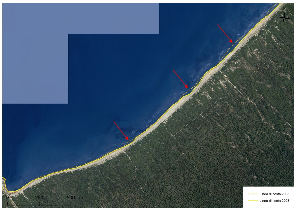
Figura 11. Confronto delle linee di riva del 2008 e del 2022. Le frecce rosse indicano i settori in cui lo scostamento della prima rispetto alla seconda si attesta tra 20÷30 m, portando a una riduzione della superficie emersa della spiaggia e alla formazione di una ripa di erosione al piede del sistema dunale.
