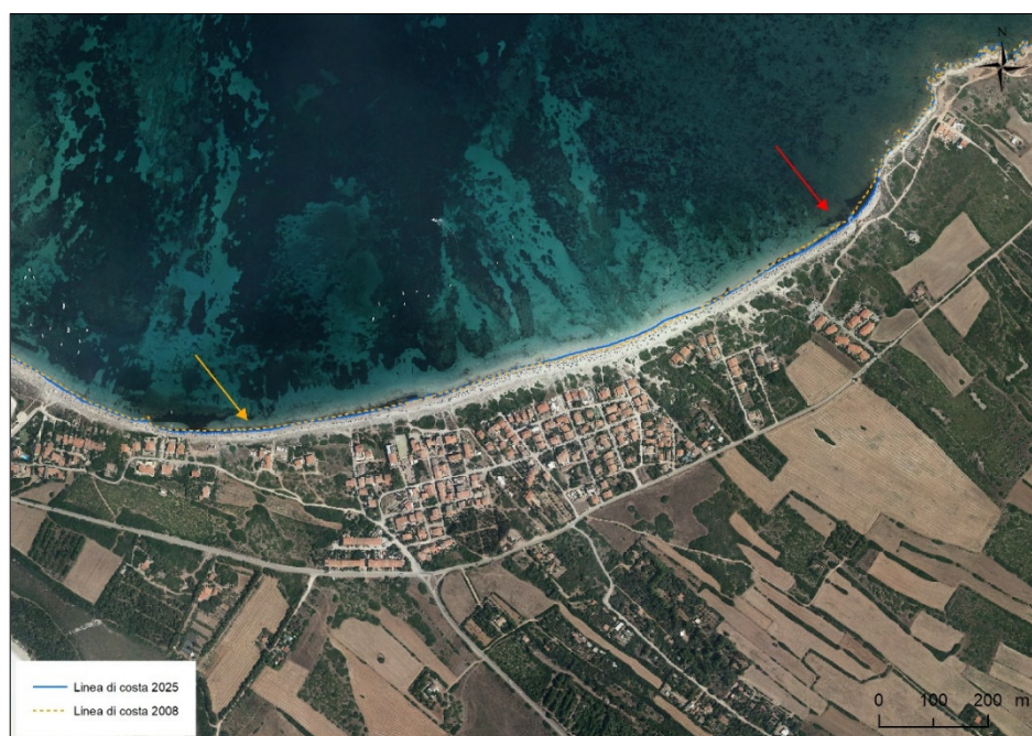
Figura 7. La freccia arancione indica il settore di spiaggia interessato dai fenomeni di accumulo e di Posidonia oceanica con la conseguente formazione di banquettes . La freccia rossa indica un settore in erosione
