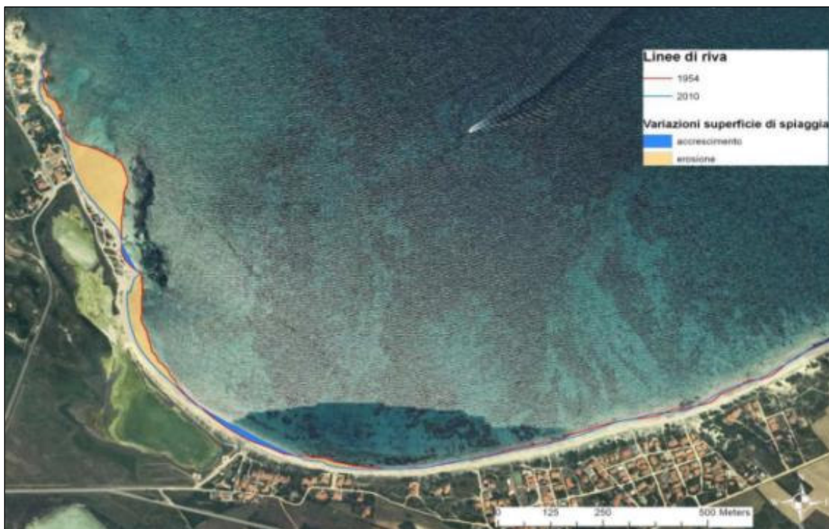
Figura 5. Evoluzione storica della linea di riva a Su Pallosu, tratto dal progetto "Interventi urgenti per la messa in sicurezza dei tratti di maggior rischio e alla mitigazione degli effetti delle dinamiche erosive nei punti di maggior intensità e incidenza nella linea costiera". Si noti il progressivo arretramento della spiaggia nel settore occidentale e la generale stabilità di quello orientale
