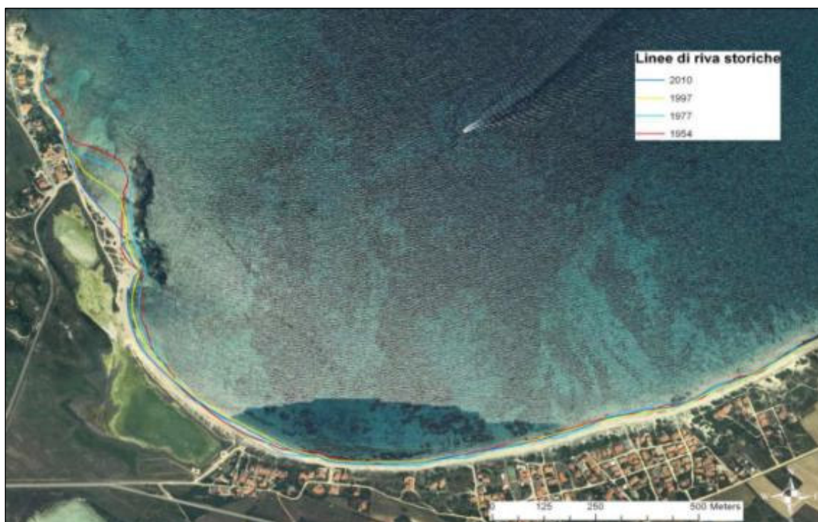
Figura 6. Variazioni della superficie di spiaggia dal 1954 al 2010, tratto dal progetto "Interventi urgenti per la messa in sicurezza dei tratti di maggior rischio e alla mitigazione degli effetti delle dinamiche erosive nei punti di maggior intensità e incidenza nella linea costiera".
